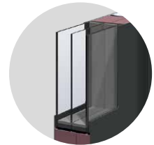
TRIPLE VITRAGE Avec une face feuilletée 33/2 retardateur d'effraction en standard (44/2 ou SPI0 en option)
